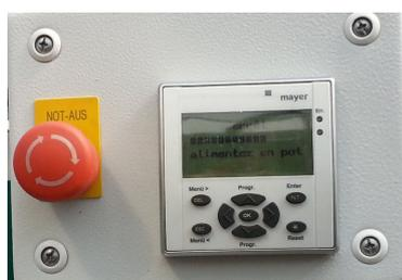
**Contrôle PLC** : pour mémoriser les différentes vitesses de moteur (alimentation terreau et rotation) en fonction des diamètres de pots
