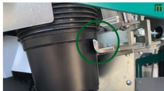
Positionnez la mâchoire de maintien inférieur sous le bord du pot
