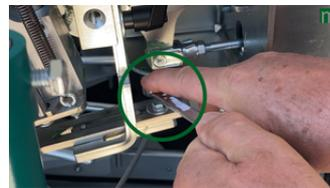
Resserrez la vis de verrouillage
