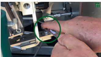
Pour régler le diamètre inférieur du pot, desserrez la vis de verrouillage avec une clé à fourche
