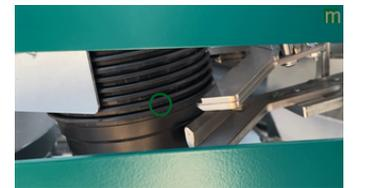
Ajustez la distance entre les pots afin que la mâchoire de maintien supérieure et l'éjecteur soient entre les deux derniers pots
