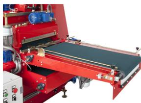
→ **Tapis de sortie RME63** : tapis de connexion entre remplisseuse RME63 et une autre machine.
