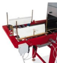
→ **Empileur de plaques AC** : empileur de plaques simple sans table tournante. Permet d'empiler les plaques en sortie de ligne. Compatible tout type de remplisseuse MOSA.
