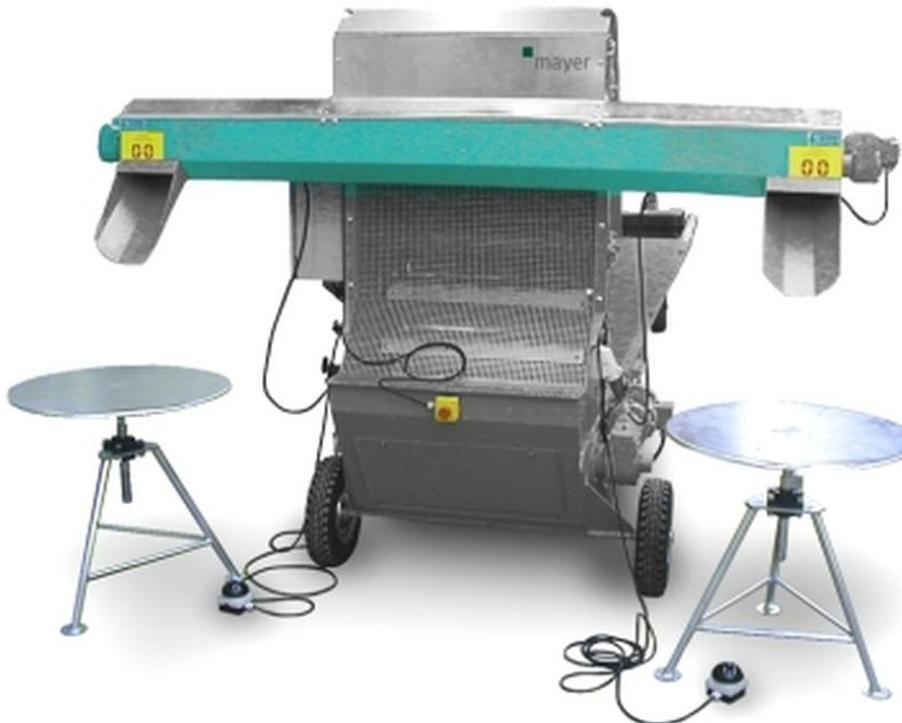
La machine à repoter Mayer TM1018 est conçue spécialement pour les horticulteurs. Elle permet de repoter des contenants jusqu'à 400 litres.
