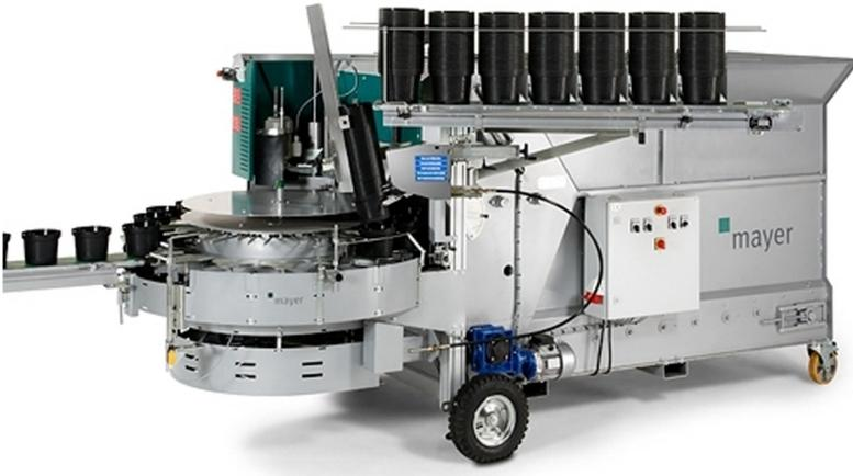
Cette rempoteuse est utilisable pour des pots de 8 à 26 cm qu'ils soient ronds ou carrés. Elle offre un rendement pouvant atteindre 4 000 pots par heure. La rempoteuse TM 2400 est dotée d'une trémie de 1,5 m<sup>3</sup> pouvant atteindre 3 m<sup>3</sup> avec une extension.
