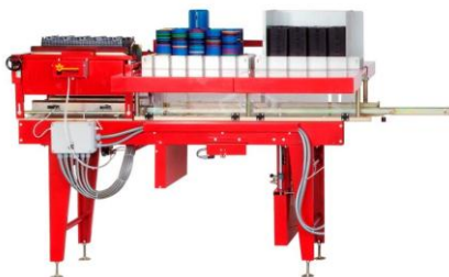
Distributeur de pots type D14G : Adaptable sur remplisseuse R12N Distribution de pot en plaque avec 1 station de dépilage de plaques et 2 stations de dépilage de pots par système de fourches (sans réglage)
