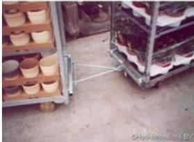
**Couplage entre 2 rolls comprenant 1 attache avant et arrière + 1 triangle (ref.ECC2)**
