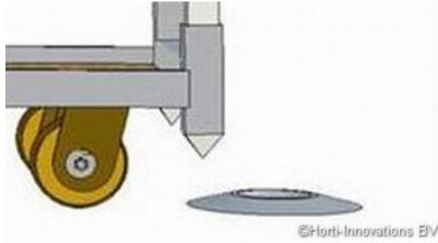
**Disque de blocage :** avec une roulette placée au centre du disque de blocage, le chariot danois se trouve fixé au sol.
